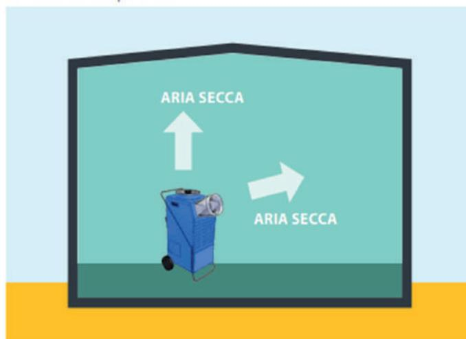
**ASCIUGATURA DI SALA.** Con l'ACD 137 posizionato all'interno della stanza, l'aria secca viene immessa nella stanza. L'umidità rimossa dall'aria viene raccolta in un serbatoio.
